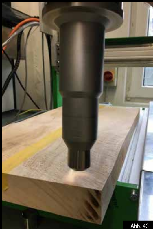
Abb. 43: Aktivierung von Holz vor dem Lackieren mit dem Atmosphären- druckplasmaverfahren
