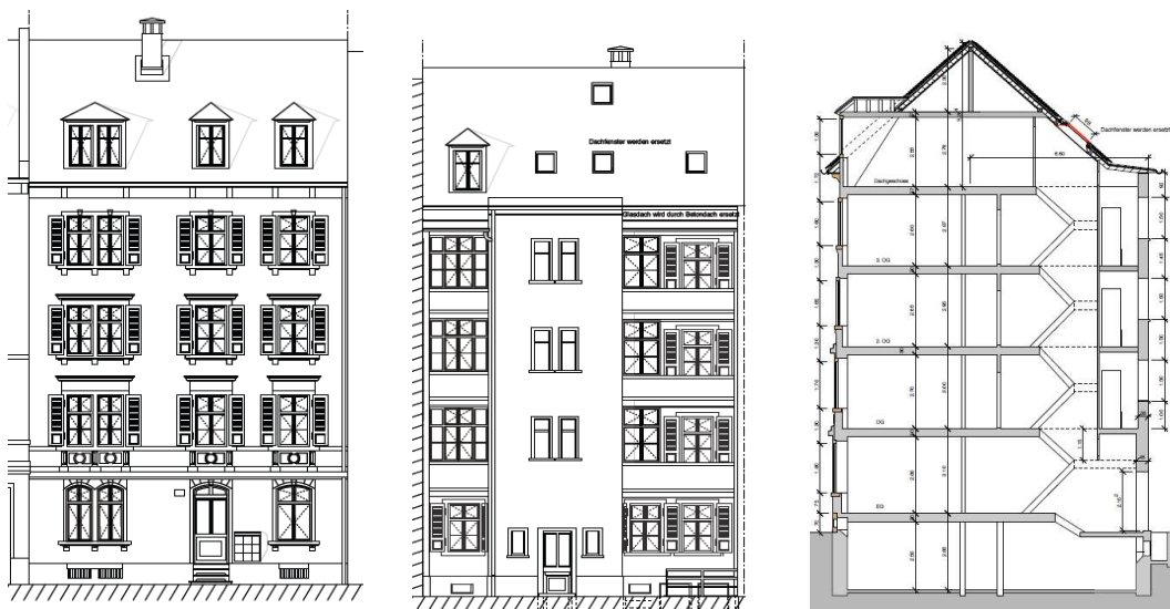
Abbildung 1: Links: Strassenansicht, Mitte: Ansicht hofseitig, Rechts: Vertikalschnitt
